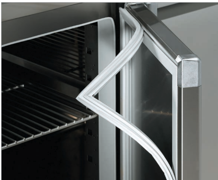
Tætningslisterne er fastgjort efter "svalehaleprincippet" og er derfor meget lette at udskifte.
