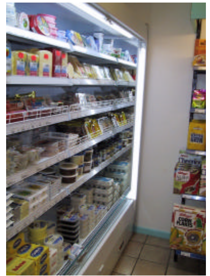
Frontgitre holder på varerne, når hylderne skråtstilles. Spejlgavlen får kølereolen til at virke længere
